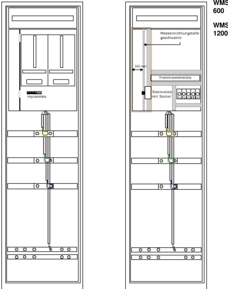
Das **Kommunikationsfeld** dient zur Aufnahme der Anschlussklemmen für die Impulsweitergabe sowie diverse Zählerschnittstellen.
