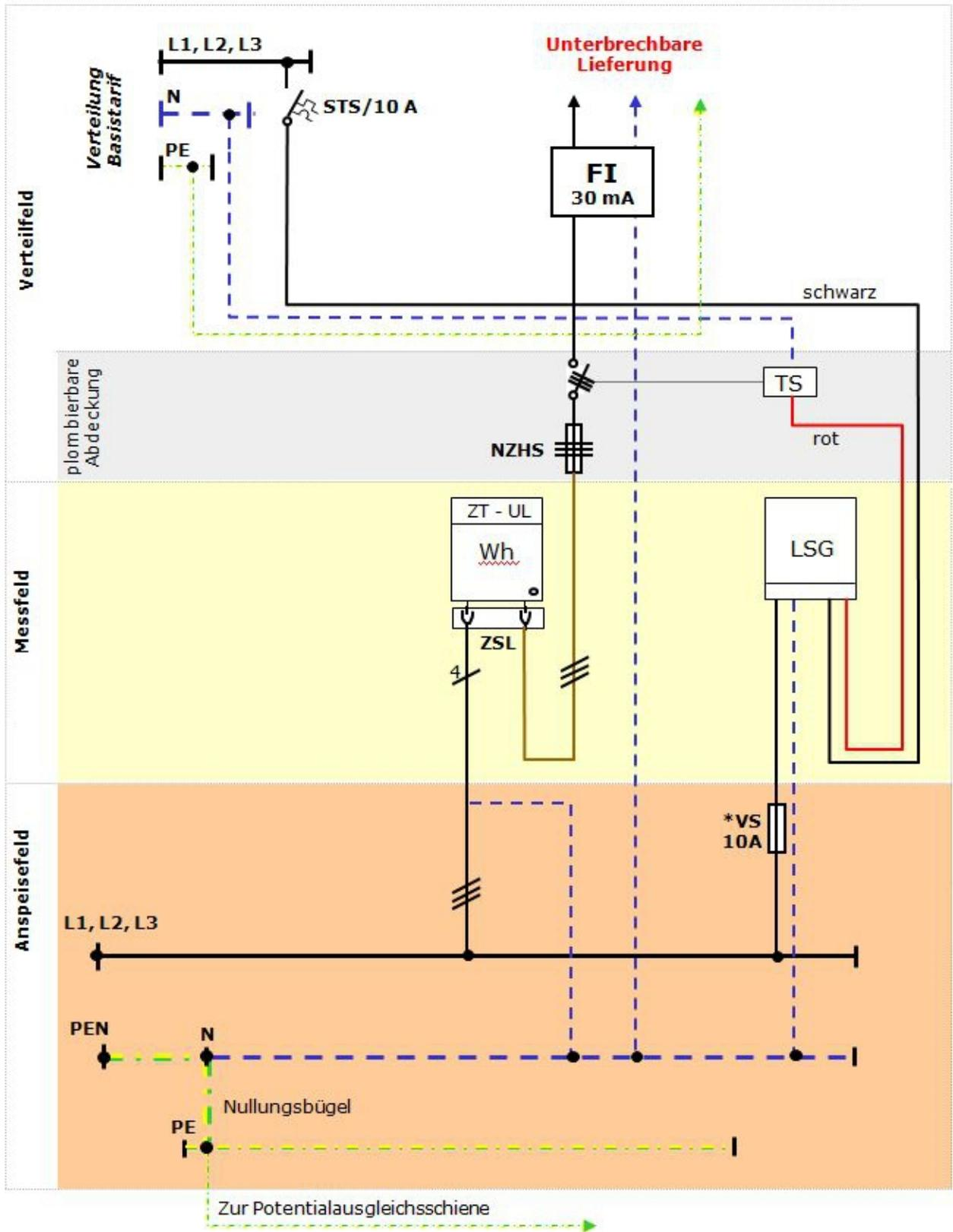
Unterbrechbare Lieferung für Kirchenbankheizung, Ausführungsbeispiel für Direktmessung mit maximal 50 A Nennstrombedarf.
