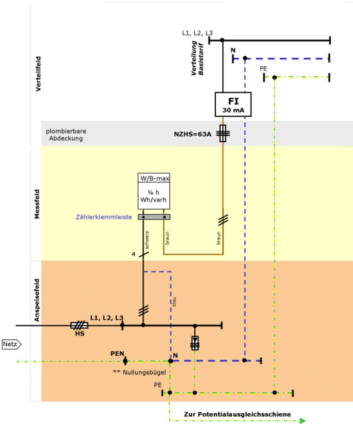
Tarifschaltbild: TN-System mit Maximumzählung, Zähleklemmleiste und NZHS 63A
