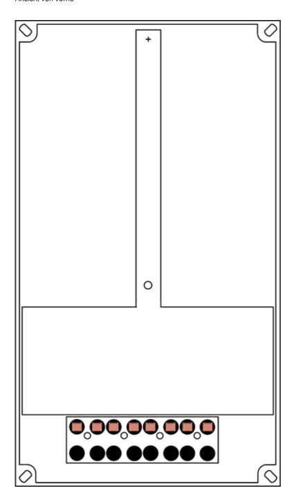
Positionierung der ADOCK Steckleiste auf der Zählerplatte
