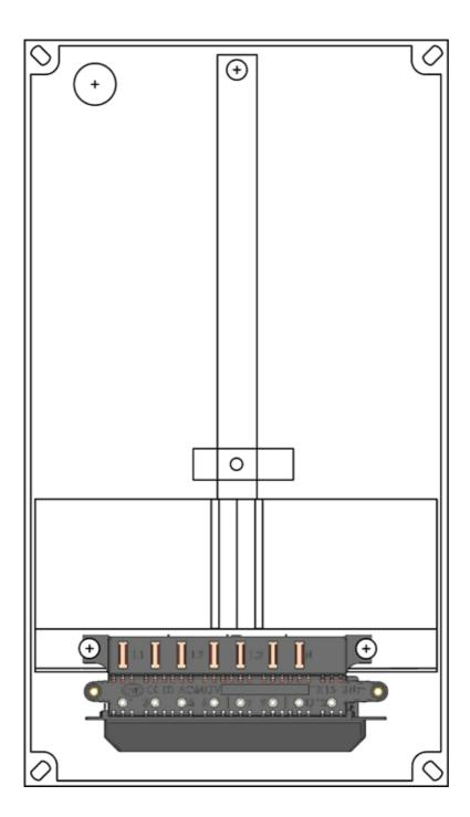
Positionierung der ADOCK Steckleiste auf der Zählerplatte
