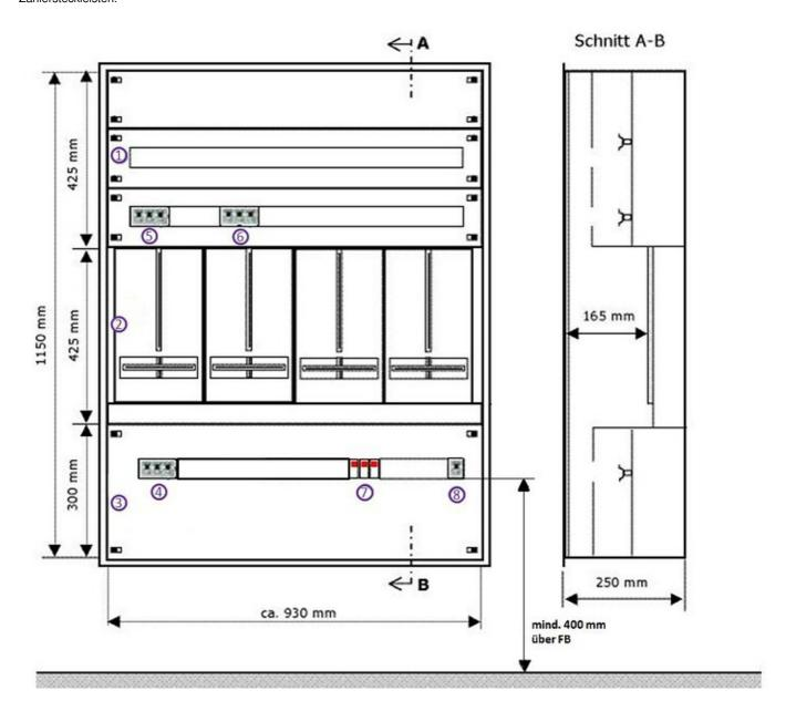
Abbildung: Standard-Zählerverteilerschrank für OÖ.
